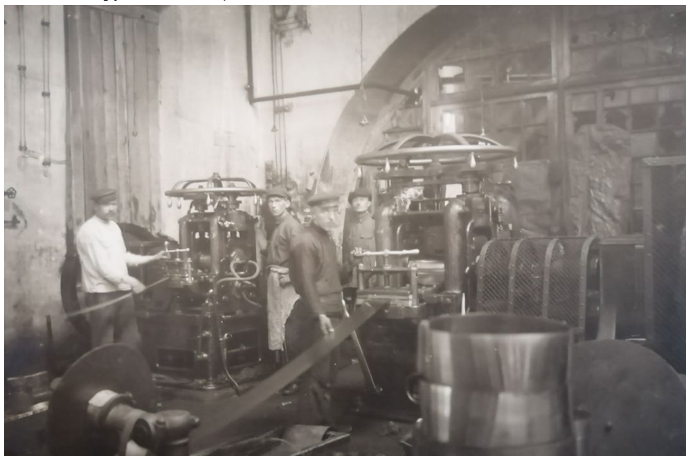
Латунный завод, лентопрокатные машины (фото предоставлено куратором музея АО «Электрокабель» Кольчугинский завод» И.В. Аккуратновой. При использовании фото ссылка на музей АО «Электрокабель» Кольчугинский завод» обязательна).
