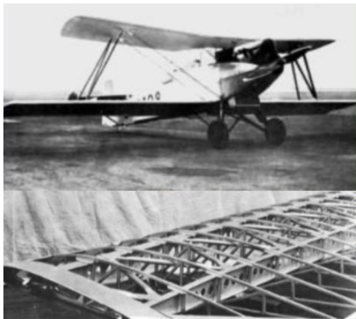
Двухместный самолет Albatros L 81 «Electra» (вверху) и его необшитое нижнее крыло - все конструктивные элементы выполнена из магниевых сплава (электрона) AZM [155, 158].
