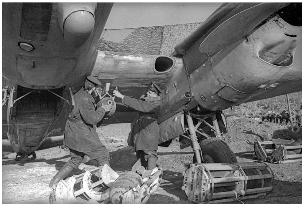
Снаряжение авиационными бомбами на пикирующего бомбардировщика Пе-2 [224]. На фото хорошо видна клепаная обшивка самолета листами из сплава М95 (Д6).
