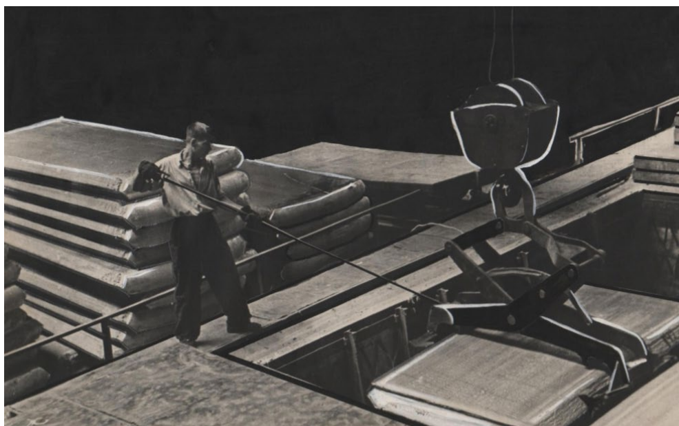
Прокатный цех №42 Ступинского завода. Загрузка плоских слитков в колдцевые печи гомогенизации. Фото приведено для иллюстрации размеров прокатываемых заготовок [322].
