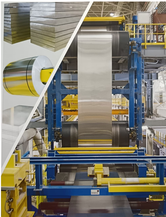
На фото представлены катанная продукция ОАО «КУМЗ»: плиты, листы, рулон, - из алюминиевых сплавов и работающий стан рулонной прокатки лент из алюминиевых сплавов [360].
