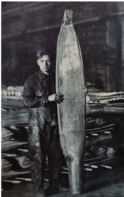
Типовая штампованная лопасть воздушного винта из сплава системы алюминий-магний-кремний [146].
