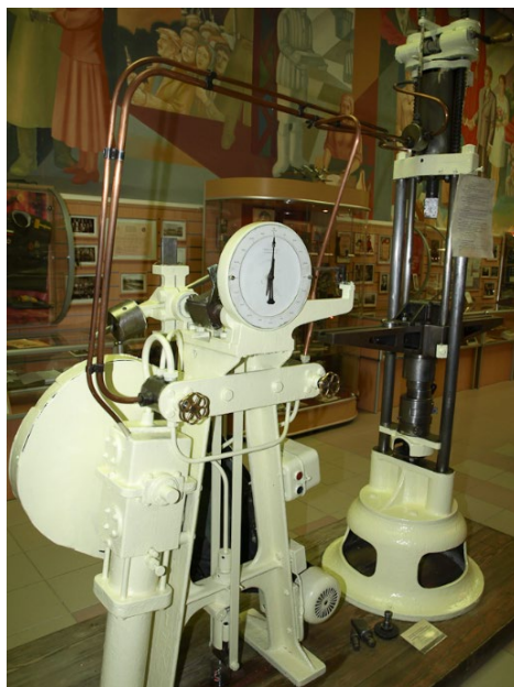
Разрывной пресс Амслера (фото Романа Гусарова, руководителя интернет-портала AVIA*RU Network) предназначен для испытания образцов труб на растяжение, раздачу, сплющивание и на изгиб плоских образцов.
