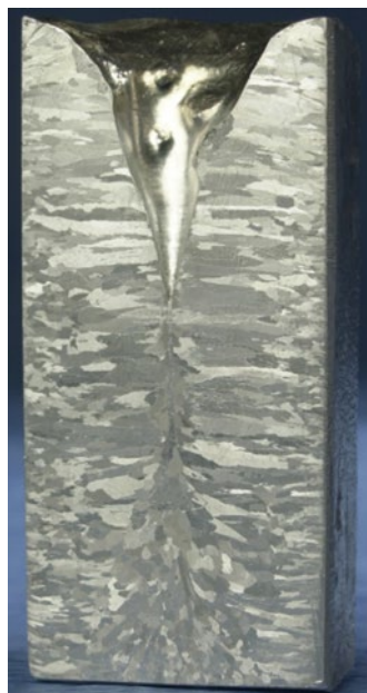
Разнородная структура алюминиевого слитка [368].
